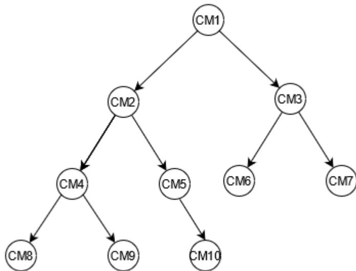
In diesem Handbuch werden dieser Baum und seine Komponenten-IDs als Referenz verwendet. Eine der obersten Komponenten wird als Elternteil bezeichnet und eine Unterkomponente wird als Kind bezeichnet. Beispielsweise CM1 ist die oberste Komponente das übergeordnete Element von CM2 und CM3. CM2 ist das übergeordnete Element von CM4 und CM5. Dadurch werden die Eltern-Kind-Beziehungen grafisch dargestellt.
