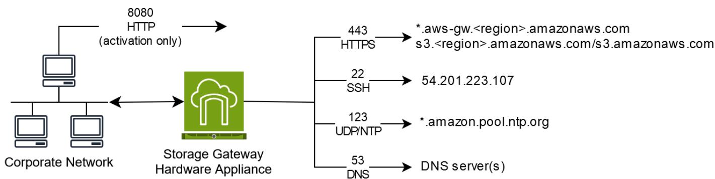
Un dispositivo de hardware requiere los siguientes puertos para funcionar.
