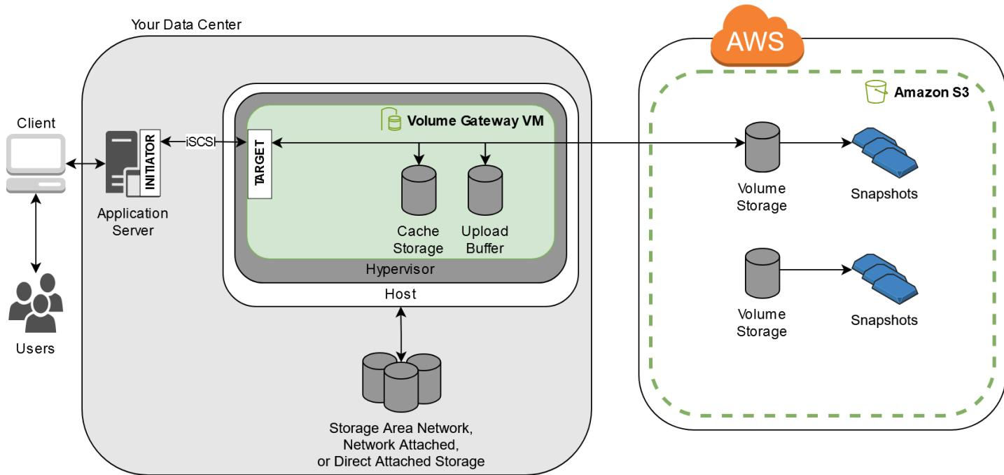
Dopo aver installato l'appliance software Storage Gateway, la macchina virtuale, su un host del data center e averla attivata, la usi per effettuare il provisioning dei volumi di storage supportati Console di gestione AWS da Amazon S3. È inoltre possibile effettuare il provisioning dei volumi di storage in modo programmatico utilizzando l'API Storage Gateway o le librerie AWS SDK. È quindi possibile montare questi volumi di storage sui server applicativi locali come dispositivi iSCSI.
